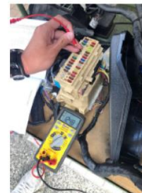
圖 8. ECM 電腦主電源的 15A 保險絲量測
